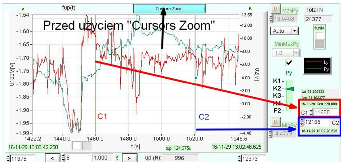
Rys. 8. Skalowanie metodą Cursors Zoom. Na wykresie widać wybrany do dalszej analizy fragment ograniczony kursorami C1 (próbka 11680 ~ 1460s) i C2 (próbka 12165 ~ 1520.625 s)
