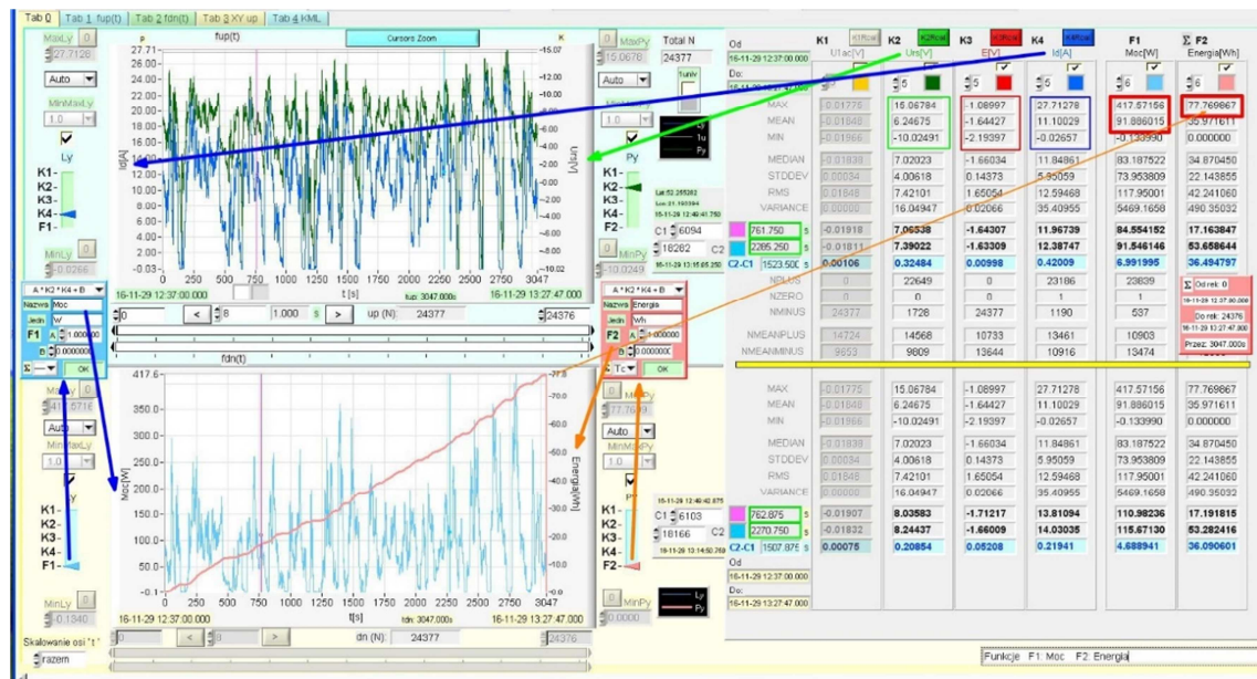
Rys. 19. Wykres górny: K4 (oś lewa) prąd I_d [A]; K2 (oś prawa) napięcie U_{rs} . Wykres dolny f_{dn}(t) w polu F1 A = 1, B = 0, F1 = K2 * K4
