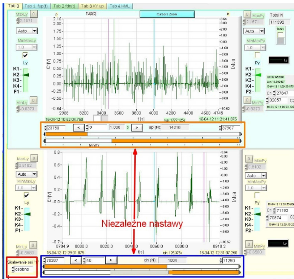
Rys. 11. Opcja 'Osobno'. Skalowanie dolnego wykresu f_{dn}(t) w osi czasu
