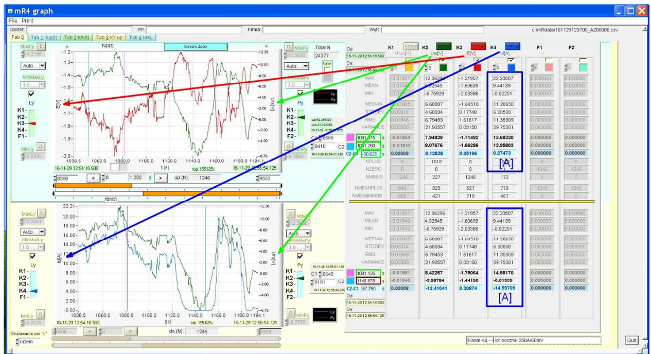
Rys. 17. Po rekalibracji: wielkości mierzone K2 – U_{rs} [V], K3 – E [V], K4 – I_d [A]
