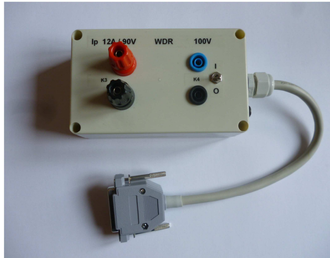
Rys. 2.4.2. Wtyczka dedykowana WDR 12A, 90V, kanał K3 . Pomiar potencjału \pm 100V , kanał K4 . Widok
