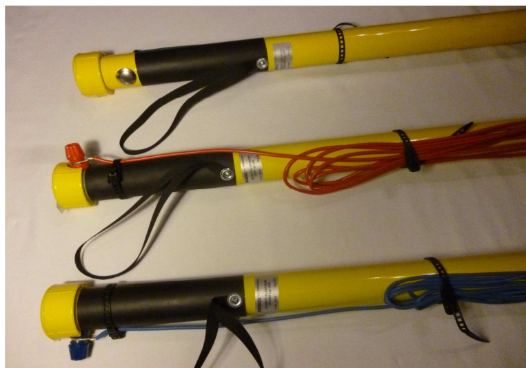
Rys. 3.1.1 Uchwyty elektrod UE (rękojeści). Od góry: w uchwycie UE , widoczny przycisk akceptu, w środku: w uchwycie UEL do zacisku przypięty czerwony przewód pomiarowy, u dołu: w uchwycie UER do zacisku przypięty niebieski przewód pomiarowy
