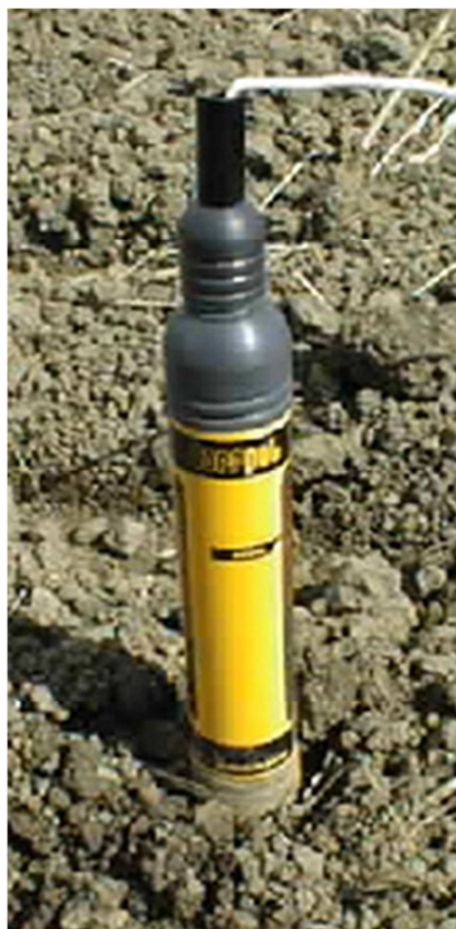
Rys. 3.3 Przenośna elektroda odniesienia typu EO-30/Cu prod. CORRPOL. Widok
