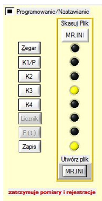
Rys. 6. Panel główny, pole wyboru nastaw (tu: aktywne diody wskazują nastawy do zapisu w pliku MR.INI)
