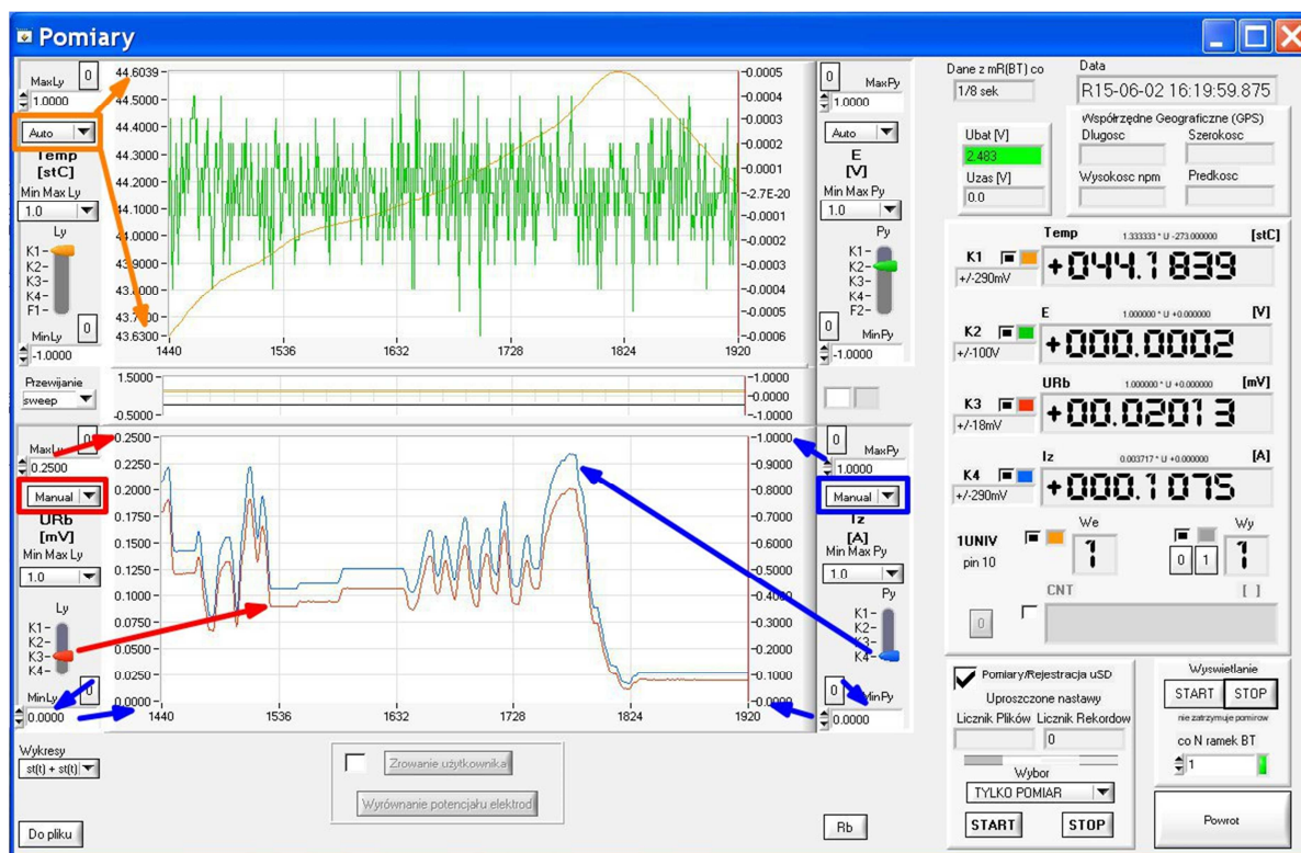
Rys. 18. Panel „Pomiary”. Skalowanie wykresów analogowych (tu: rejestrator mR4 )
