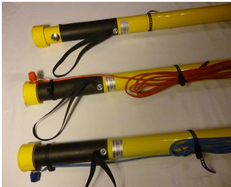
Uchwyty elektrod, u góry: środkowy UEP , widoczny przycisk nad rękojęcią, lewy UEL , prawy UER
