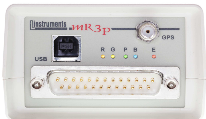
Rys. 7. Płyta czołowa rejestratora mR3p . Widoczne diody LED
