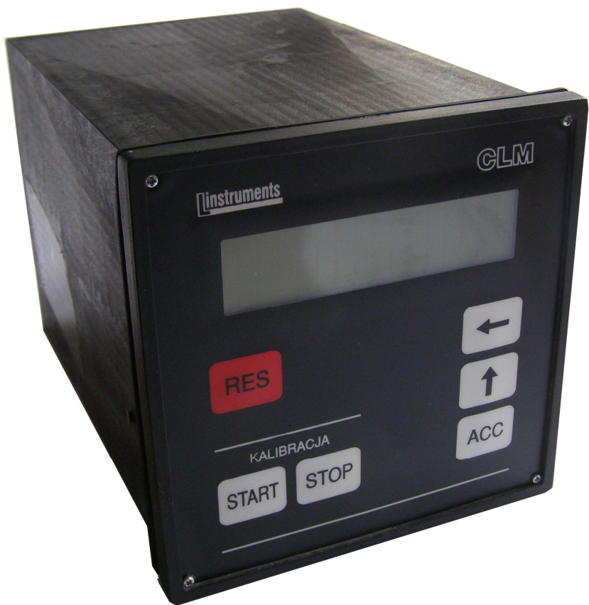
1-2 Mikroprocesorowy miernik długości MMD. Widok z przodu
